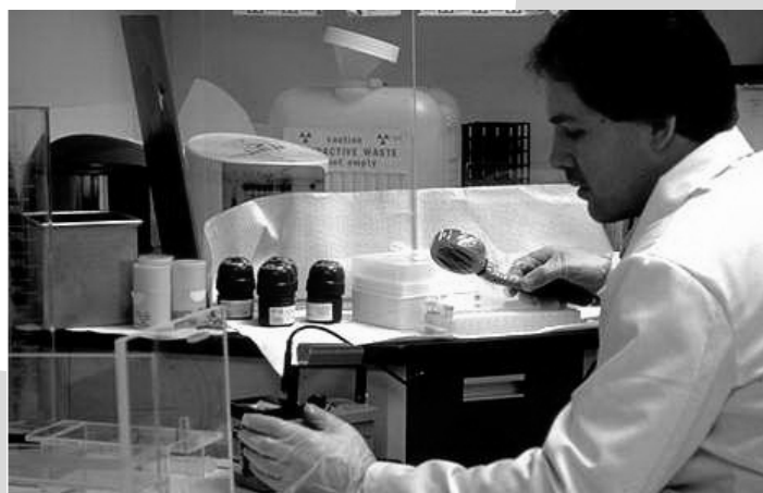
Figura 2 — Verificação do nível de radioactividade com um contador Geiger
